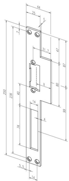
Lappenschließblech mit Fallen- und Riegelausschnitt.
