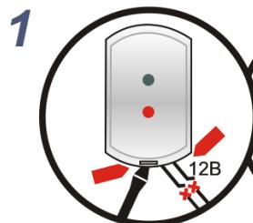
При отключенном электропитании снять крышку корпуса РПУ.
