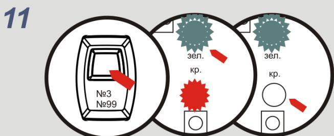
Если при повторном нажатии кнопки регистрируемого браслета зеленый индикатор РПУ загорится 2 раза и перейдет в режим вспышек 1 раз в 4 сек. - неудачная регистрация. Повторить операции 4, 8, 9, 10, или проверить соответствие количества регистрируемых браслетов варианту исполнения РПУ.
